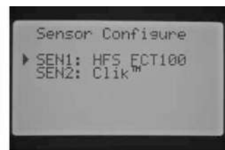
SEN 1 – датчик потока (HFS FCT100) SEN2 – метеодатчик
