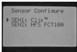
SEN 1 – метеодатчик SEN2 – датчик потока (HFS FCT100)
