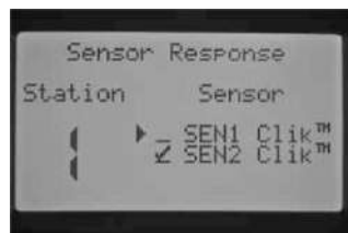
Только 2й датчик запрограммирован на 1ю зону
